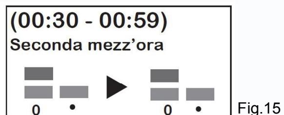
Dunque: La programmazione della temperatura nella SECONDA MEZZ'ORA di ogni ORA, NON comporta nessuna modifica alla colonna dell'ORA corrispondente, anche se viene impostata una temperatura differente rispetto alla temperatura della PRIMA MEZZ'ORA. Sul display otterremo un andamento grafico delle temperature programmate durante l'arco della giornata. A seconda dell'ORA in cui ci si trova, lampeggia il cursore della temperatura corrispondente.
