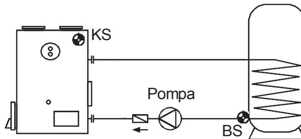
La pompa si attiva quando il sensore **KS** è superiore alla soglia **max** (qui usato come „min“) ed il sensore **KS** è superiore per la differenza **diff** rispetto al sensore **BS**.
