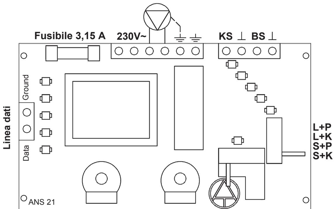
Quando si utilizza la funzione Master-Slave è necessario che la linea dati venga collegata ai due apparecchi **con la stessa fase** (Data su Data, Ground su Ground).
