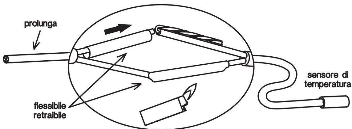
Per evitare oscillazioni di misurazione è necessario prestare attenzione ad una trasmissione del segnale priva di interferenze e che i cavi del sensore non siano esposti a degli influssi negativi. Nel caso in cui si utilizzino cavi non schermati, i cavi dei sensori ed i cavi di rete da 230V devono essere posati in canaline separate e con una distanza minima di 5 cm.
