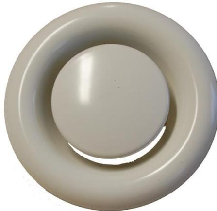
Valvola di ripresa DN100 per impianti di Ventilazione Meccanica Controllata, dotata di fungo centrale regolabile manualmente e realizzata in acciaio verniciato bianco. Studiata per l'installazione a controsoffitto.
