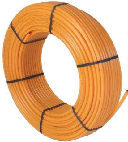
La tubazione per riscaldamento e raffreddamento a pavimento, parete e soffitto in polietilene PE-Xc di EHT Italia è caratterizzata da una reticolazione realizzata con bombardamento elettronico mediante raggi di tipo gamma, con grado minimo del 60%.
