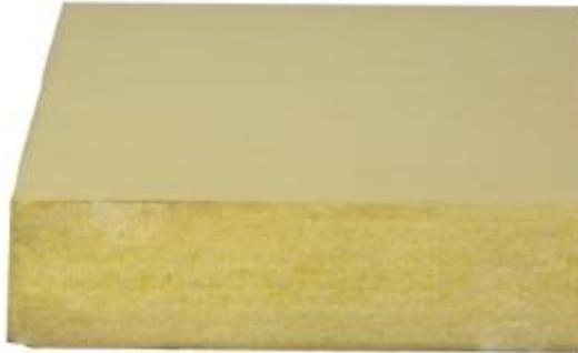
Il pannello termoisolante in **POLISTIRENE ESPANSO ESTRUSO XPS300** conforme alla norma EN13164, è idoneo a sostenere carichi più elevati rispetto ai normali pannelli isolanti. Prodotto per l'impiego sotto massetto, deve essere protetto dal foglio di protezione ermetica. La posa dell'impianto può avvenire o tramite barre fermatubo con tubi di diametro da 12 mm a 25 mm, o tramite rete metallica e clip per tubi diametro esterno da 16 – 20 mm.
