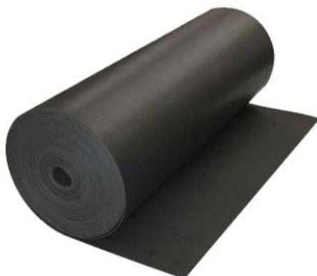
Materassino in polietilene espanso di spessore 5 mm utilizzato per migliorare le performance di abbattimento del livello di pressione sonora da calpestio nei solai. Fornito in rotoli di altezza 1500 mm, densità 30 kg/mc per una lunghezza di 50 m da stendere sotto il pannello isolante.
