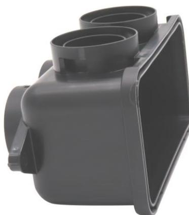
Plenum per bocchetta di mandata e di ripresa realizzato in plastica di alta qualità. È dotato di un doppio attacco laterale e posteriore che permette il perfetto innesto del tubo DN 63 e due supporti per il fissaggio.
