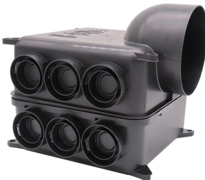
Plenum di distribuzione aria, realizzato in plastica di alta qualità, garantisce un'ottima ripartizione della portata nella più totale silenziosità. Il plenum è dotato di un attacco bocchettonato diam. 150mm e fino a un massimo di 12 attacchi bocchettonati per tubo DN 63.
