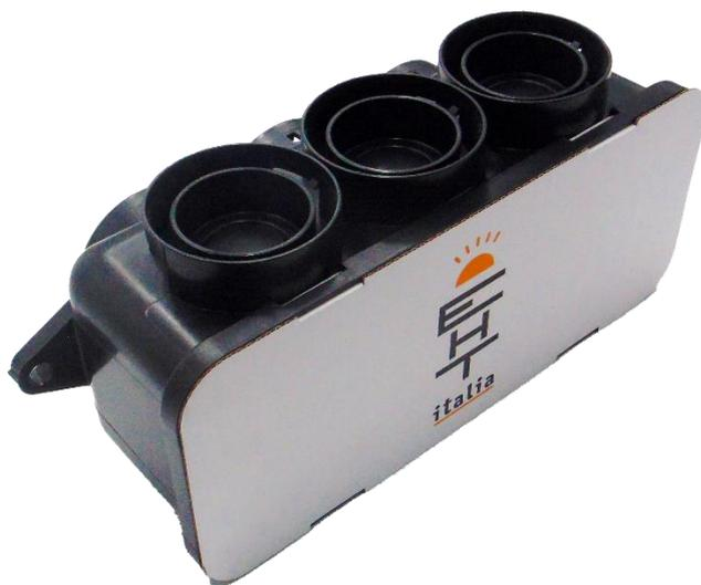
Plenum per bocchetta di mandata e ripresa, realizzato in plastica di alta qualità, garantisce un'ottima ripartizione della portata nella più totale silenziosità. Il plenum è dotato di triplo attacco laterale e posteriore che permette il perfetto innesto del tubo DN 63. È dotato di due supporti laterali per il fissaggio. Completo di paramalta.
