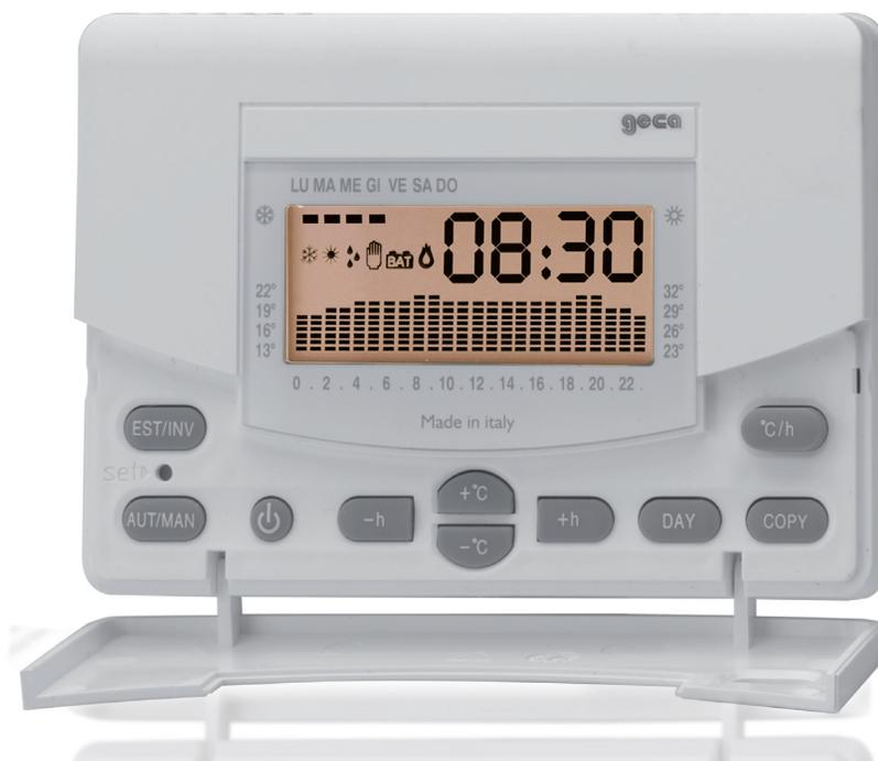
CRONOTERMOSTATO DOTATO DI SENSORE PER LA RILEVAZIONE DELL' UMIDITÀ E DI DOPPIO RELÉ. IL PRIMO RELÉ É COMANDATO COME SU TUTTI I CRONOTERMOSTATI DALL'IMPOSTAZIONE DELLA TEMPERATURA MENTRE IL SECONDO SI ATTIVA AL RAGGIUNGIMENTO DELLA SOGLIA DI UMIDITÀ IMPOSTATA PER COMANDARE, AD ESEMPIO, UN DEUMIDIFICATORE.
