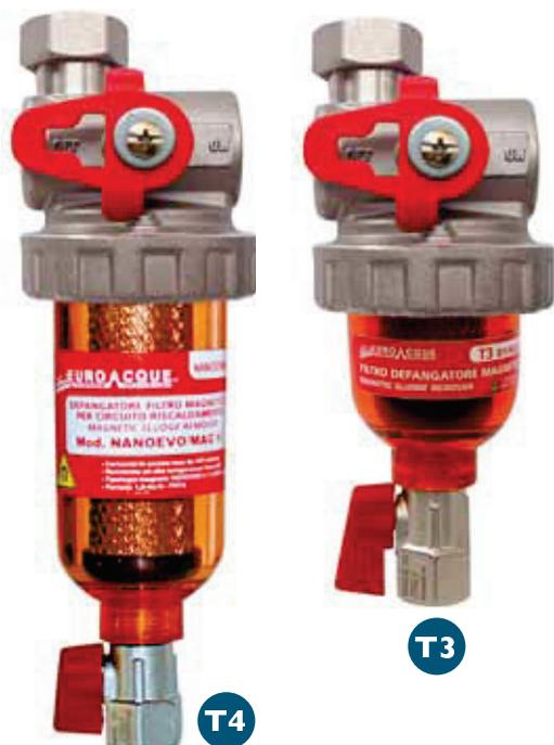
Mini defangatore filtro magnetico con attacco a squadra, codolo superiore e valvola integrata di by pass e chiusura impianto per una installazione facile, rapida e salvaspazio (con il T3 in meno di 5 cm di interasse per una altezza massima di 15 cm hai tutto, defangatore e valvola) sotto le caldaie a condensazione.
