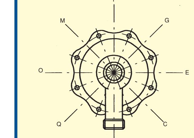
Posizione ingresso flussostato rispetto all'uscita flussostato (A)
