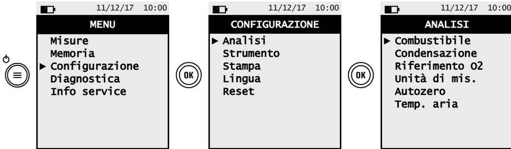
Una volta configurato nel menù analisi, premere ripetutamente il pulsante **(ESC)** per tornare alla schermata di analisi e procedere con la stessa.
