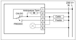
**T6360C1000** Fan-Coil (o Caldo o Freddo) Con Valvole V4043/V4044, M100+V58..4xxx
