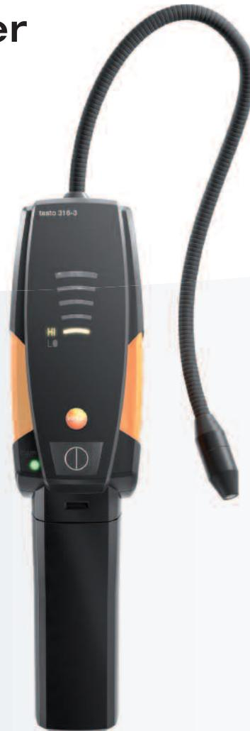
testo 316-3 è un affidabile cercafughe per refrigeranti che dovrebbe essere parte della dotazione di ogni tecnico del freddo. E' in grado di rilevare persino le più piccole fughe grazie alla sua elevata sensibilità di 4 g/a, ed è conforme alle normative SAE J1627 e EN14624.
